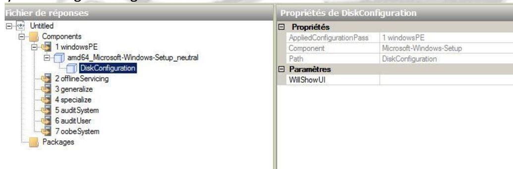
17. Nous allons maintenant faire un clic droit sur DiskConfiguration puis, sélectionner « Insérer nouveau disque ». Les détails pour le disque devront maintenant être configurés afin que WillWipeDisk soit réglé sur OnError.
